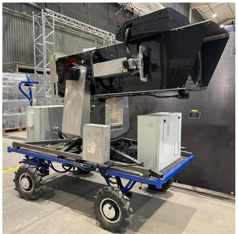
wAP menyediakan kontrol jauh dan transmisi data diagnostik dari sistem robotik yang melakukan pemeliharaan turbin angin. Keseluruhan sistem robotik beroperasi tanpa downtime untuk turbin dan dianggap lebih aman daripada solusi berbasis drone sebelumnya.
